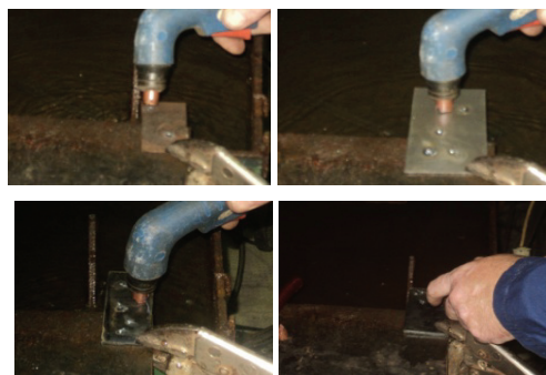
Slika 4. Probijanje otvora na debljini 1,2,3 i 4 mm
