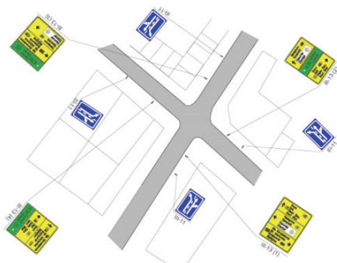
Slika 3. Pregledna karta raskrsnice br. 1. sa položajem signalizacije za vođenje saobraćaja
