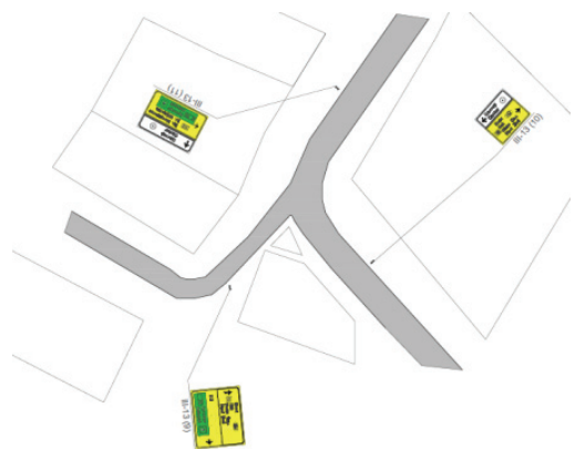
Slika 5. Pregledna karta raskrsnice br. 3. sa položajem signalizacije za vođenje saobraćaja
