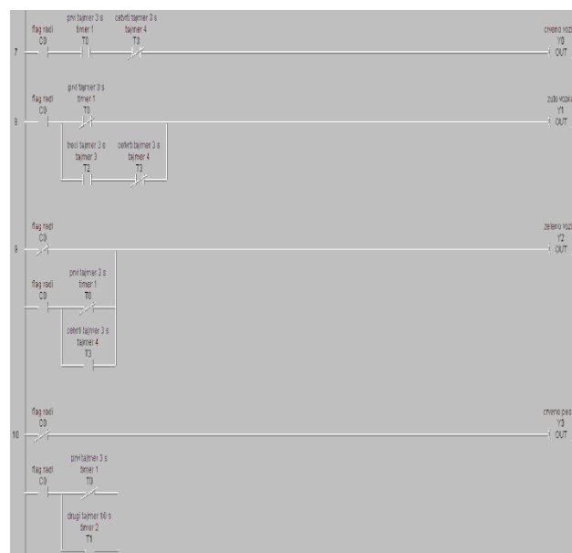
Slika 2. Uslovi za stanja semafora
