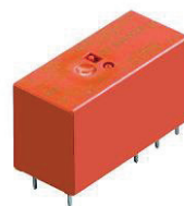
Slika 3.3. 1 Izgled releja koji je korišćen za prekidanje strujnog kola.
