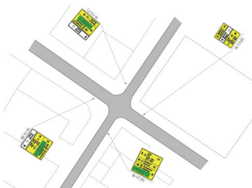
Slika 4. Pregledna karta raskrsnice br. 2. sa položajem signalizacije za vođenje saobraćaja
