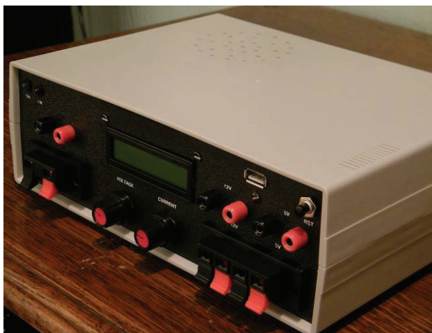
Slika 7. Konačan dizajn nakon smeštanja u kutiju
