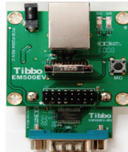
Slika 5. Tibbo univerzalni serijski konvertor
