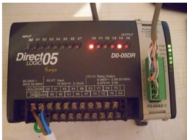
Slika 6. Stanje PLC-a kada se uključuje crveno svetlo za vozila i zeleno svetlo za pešake
