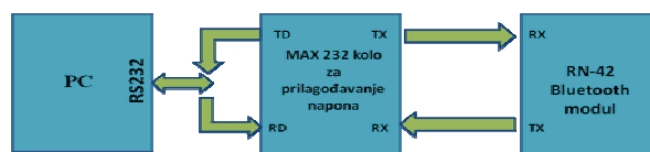
Slika 2. Blok dijagram za komunikaciju između PC računara i RN-42 bluetooth modula
