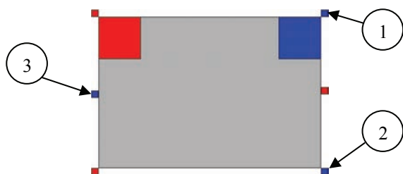
Slika 3. Pozicije držača bikona, držači obeleženi sa 1, 2 i 3 pripadaju plavoj poziciji, ostali pripadaju crvenoj
