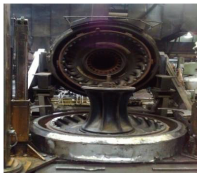
Slika 11. Presa na operaciji vulkanizacije
