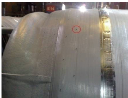
Slika 10. Guma nakon operacije bušenja
