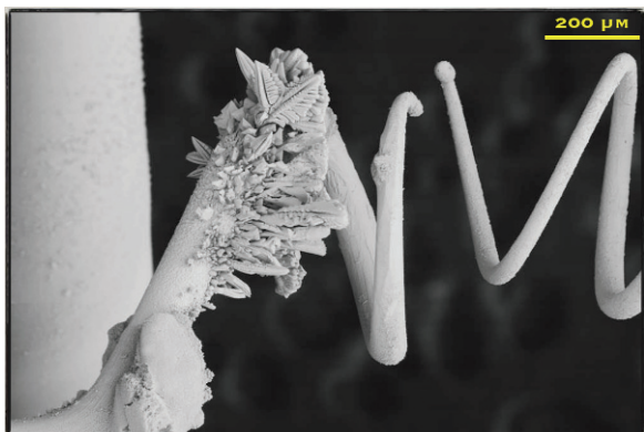
Slika 3.4 Prikaz prekinutog vlakna [1]
