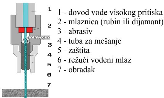
Slika 3. Izgled mlaznice sa dodatkom abraziva
