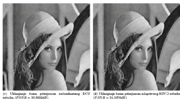
Slika 5. Rezultati uklanjanja šuma korišćenjem overcomplete DCT rečnika i rečnika dobijenog primjenom KSVD algoritma.
