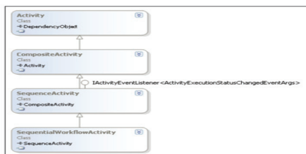
Slika 2. Dijagram klasa sekvencijalnog workflow -a [3]
