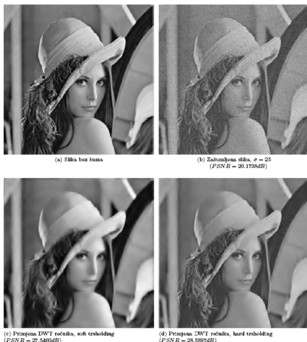
Slika 4. Rezultati uklanjanja šuma primjenom DWT rečnika i IST algoritma (soft i hard thresholding tehnike) za dobijanje sparse reprezentacije slike Lena.
