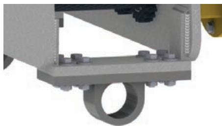
Sl. 6. Veza kolica sa pogonom dizanja
