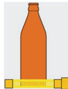
Slika 2. Visoko-frekventni (VF) uređaj za detekciju tečnosti na dnu boce
