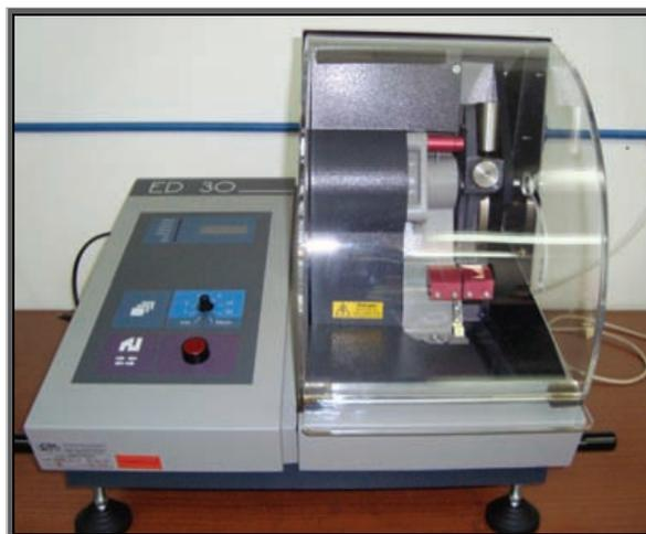
Slika 6. Uređaj marke TMI tip ED 30 za merenje otpornosti papira na cepanje
