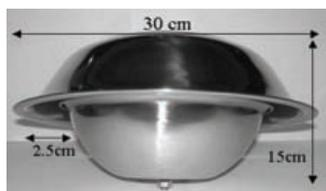
Slika 1. Dimenzije i spoljašnji izgled pasivnog uzorkivača vazduha [7]
