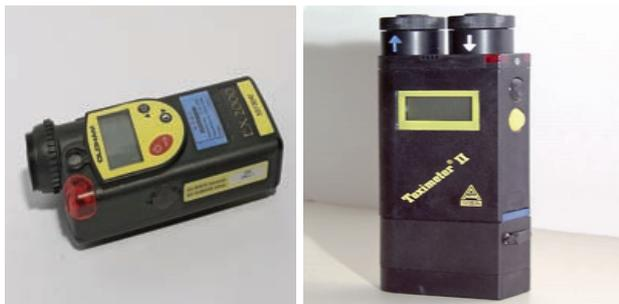
Slika 5a (levo): Detektor zapaljivih gasova i para (eksplozimetar) ISC OLDHAM tipa EX2000[9] i Slika 5b (desno): Toksimetar za merenje koncentracije toksičnih gasova, američke kompanije MSA[10]
