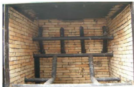
Slika 4. Dvostepena rešetka ložišta kotla termičke snage 300 Kw [4]
