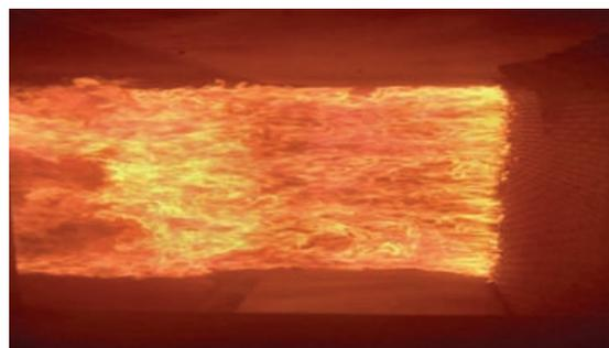
Slika 3. Ložište na baliranu pšeničnu slamu [6]
