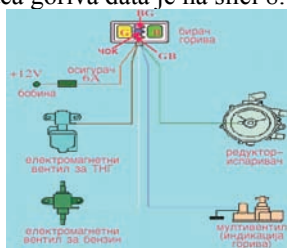
Slika 8. Povezivanje birača goriva s ostalim elementima
