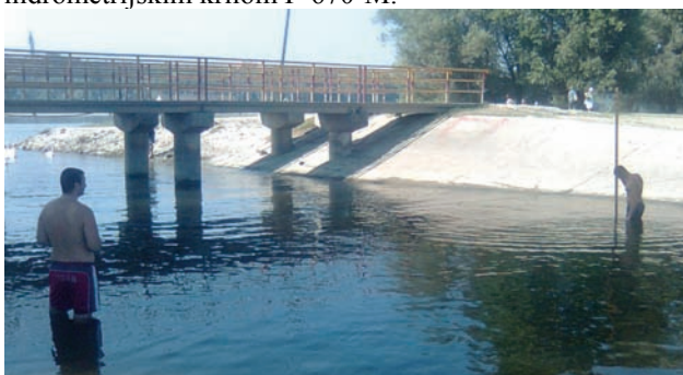
Slika 2. Merenje protoka na kanalu I posredno preko hidrometrijskog krila
