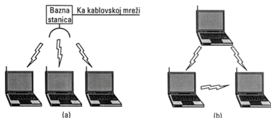
Slika 1. a) Rad u bežičnoj mreži sa baznom stanicom b) Ad hoc umrežavanje, u odsustvu bazne stanice.
