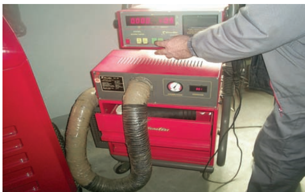
Slika 4. Spoljašnji izgled dimometra-opacimetra sa koga je vršeno merenje
