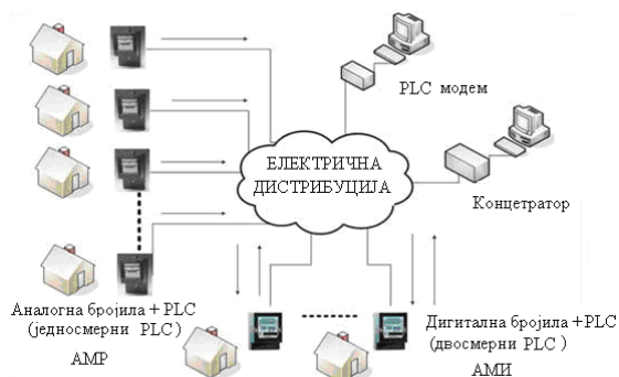
Слика 1.- Основна идеја даљинског читавања бројила [3].
