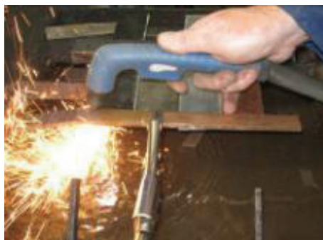
Slika 3. Rezanje uzoraka sa radnim gasom vazduhom
