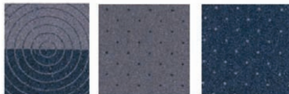
Sl. 2. Mikrolinijsko polje od 8 µm, polja s tonskom vrijednošću od 2% i 98%
