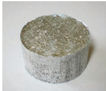
Slika 4. Uzorak dobijen od strugotine tipa 1
