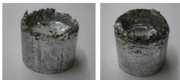
Slika 11. Suprotnosmerno istiskivanje obradaka. Levo: SSI sa žigom \phi 24,2 \text{ mm} . Desno: SSI sa žigom \phi 20,8 \text{ mm}
