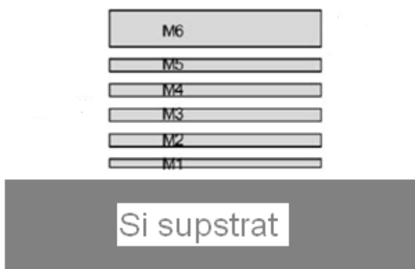
Sl. 2. Poprečni presek 0.18 \mu m CMOS strukture
