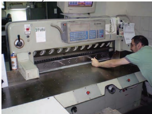
Slika 8. Zamena sečiva na mašini za sečenje
