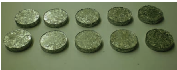
Slika 7. Sabijeni uzorci dimenzija \phi 32 \times 7 \text{ mm}
