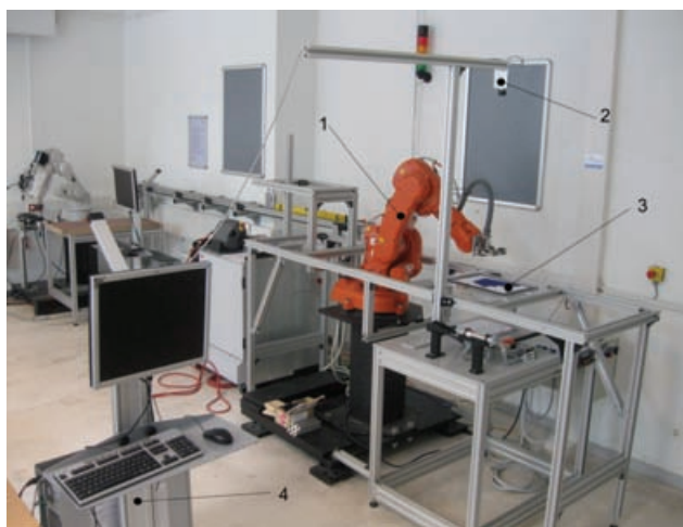
Slika 3: Izgled sistema – 1. Industrijski robot, 2. Industrijska kamera, 3. Podloga na koju se postavljaju objekti, 4. PC računar
