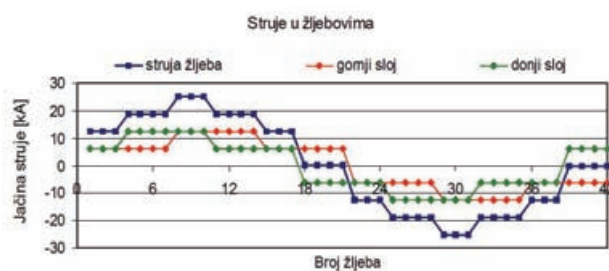
Slika 1. Raspodela struja žljebova/slojeva duž obima statora za t = 1,67 ms
