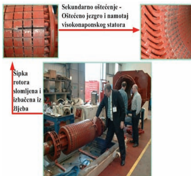
Slika 3. Lom šipke rotora
