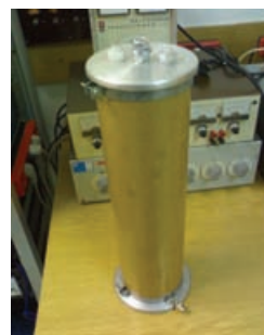
Slika 3. Fizički izgled usavršenog naponskog mernog transformatora bez jezgra
