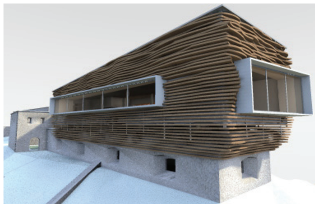
Sl.2. Novoprojektovani objekat prikaz fasadnog platna
