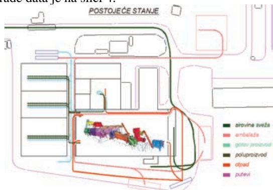
Slika 4. Šema postojećeg unutrašnjeg transporta za pogon Hladne prerade
