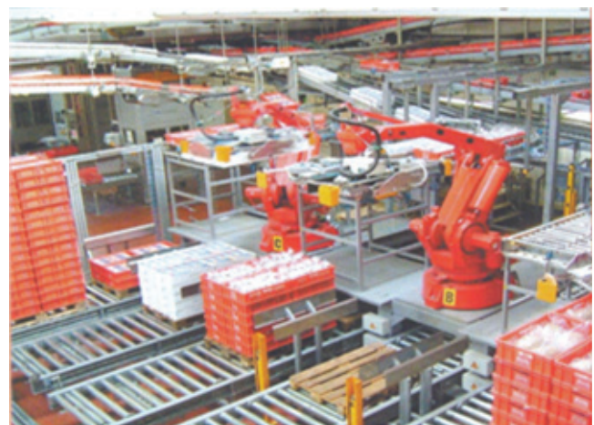
Слика 5. Аутоматизован процес палетизације
