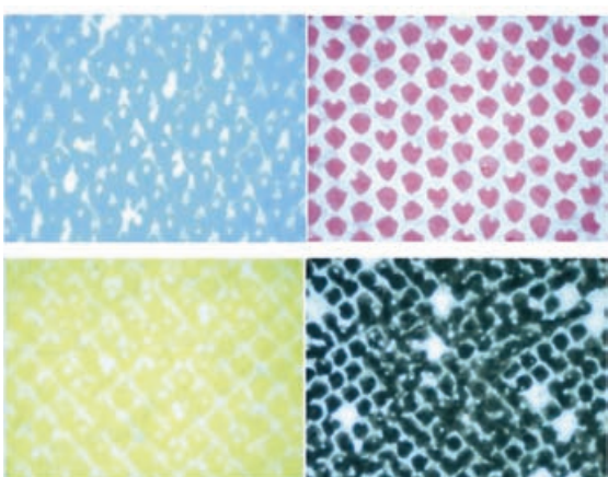
Slika 5: Prikaz izgleda polja tonskih vrednosti od 50% za četiri procesne boje (CMYK) za vrednost vremena tečenja boje od 17 sekundi
