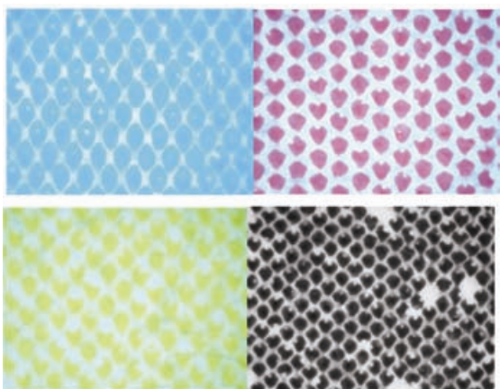
Slika 4: Prikaz izgleda polja tonskih vrednosti od 50% za četiri procesne boje (CMYK) za vrednost vremena tečenja boje od 16 sekundi
