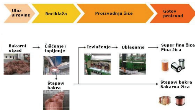
Slika 4. Proizvodnja žice od recikliranog bakra
