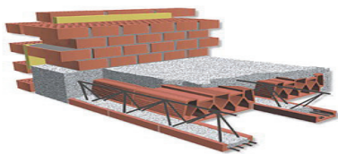
Slika 1. Izometrijski prikaz međuspratne konstrukcije tipa FERT
