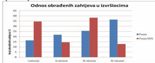
Slika 13. Odnos broja obrađenih zadataka u slučaju korišćenja četiri izvršioca i rasplinite logike
