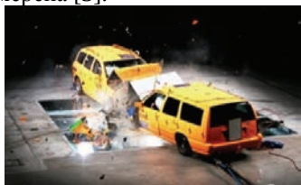
Слика 1: Централни чеони судар два аутомобила
