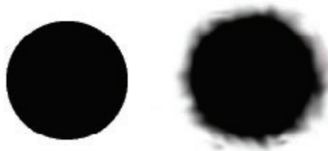
Slika 4. Prikaz rasterske tačke originala (levo) i njene deformacije posle procesa štampanja (desno)
