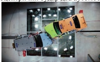
Слика 2: Ексцентрични чеони судар два аутомобила
