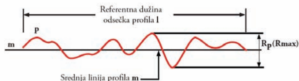
Slika 4. Presek površine za parametar R_p
