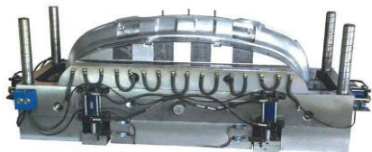
Slika 2. Izgled alata za brizganje branika automobila
