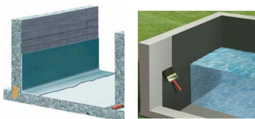
Slika 6. Nanošenje hidroizolacije Sika Lastic na betonske površine
