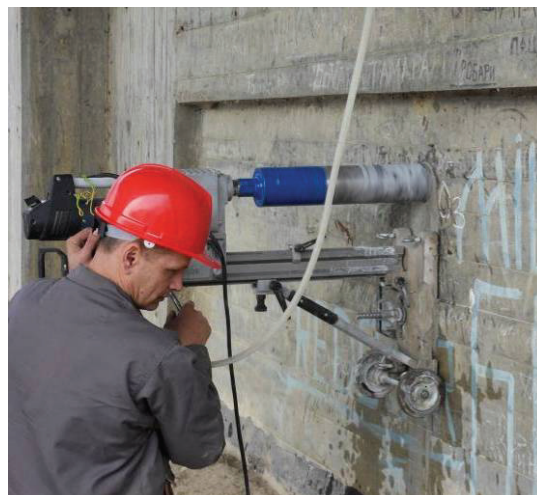
Slika 8. Postupak vađenja kernova
