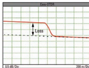
Slika 4. Trag fuzionog splajsa
