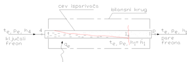
Slika 2 Energetski bilans isparivača/kondenzatora
