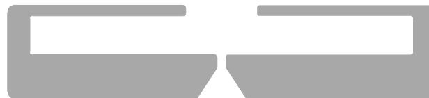
Sl.3. Dizajn odštampane UHF RFID antene
