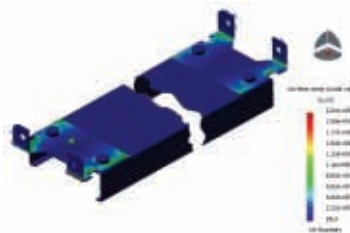
Sl. 7. Prikaz polja Von Mises-ovih napona sa listom veličina
