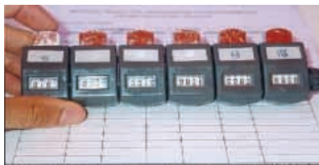
Slika 1. Uređaj za manualno brojanje prolaska motornih vozila
