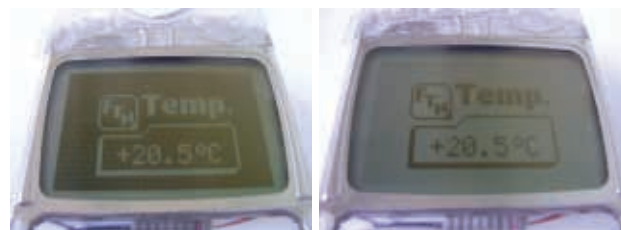
Slika 7. Displej termometra u inverznom (levo) i normalnom režimu rada (desno)
