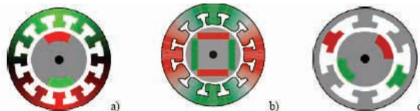
S1.2. Poprečni preseki različitih mašina sa PM: a) Sinhroni sa površinski montiranim PM, b) Sinhroni sa ugrađenim PM i c) BLDC sa površinski montiranim PM
