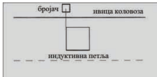
Slika 4. Automatski brojač saobraćaja Signalbau-Huber, tip SBH/DL 2000
