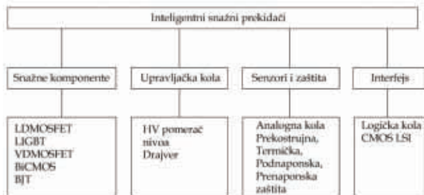
Slika 7. Funkcionalni elementi inteligentnih prekidača.
