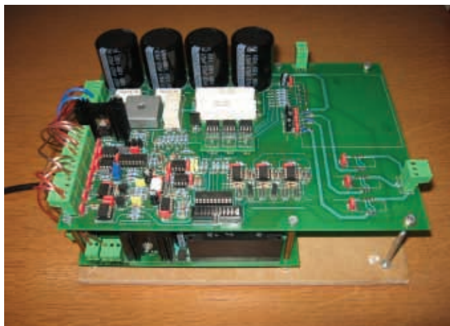
Slika 2. Izgled realizovanog frekventnog pretvarača.
