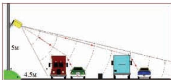
Slika 7. Način detektovanja iza visokih vozila
