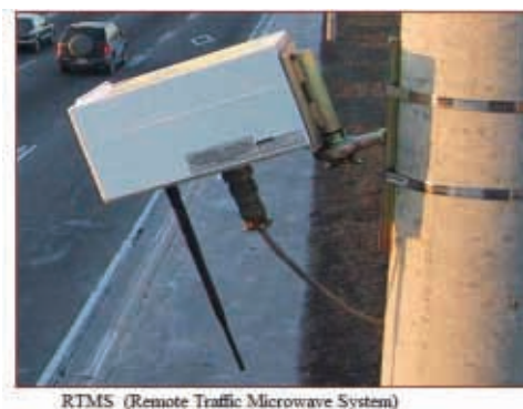
Slika 5. Izgled i način montaže mikrotalasnih detektora
