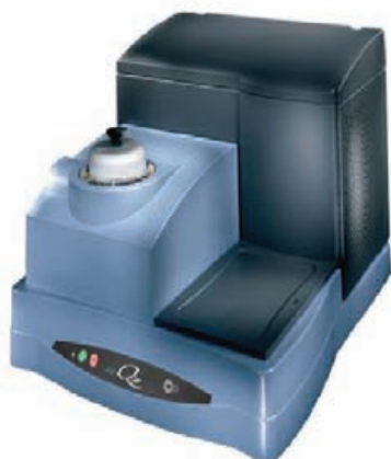
Slika 3. Instrument DSC Q20 koji je korišćen za praćenje režima umrežavanja štamparskih boja.
