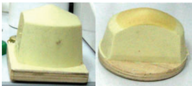
Sli.5. Silikonski tamponi kojima je vršeno štampanje uzoraka prilikom istraživanja (levo: tampon kojim je odštampana prva grupa uzoraka; desno: tampon korišćen za štampanje druge grupe uzoraka)
