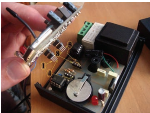
Slika 3. Montaža gornje elektronske pločice na donju
