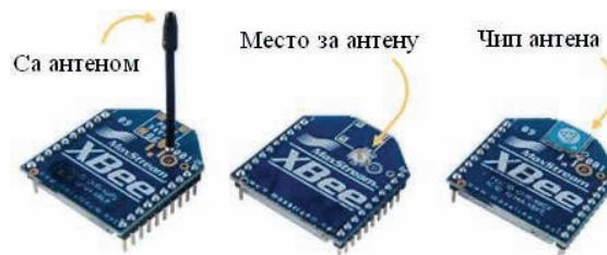
Slika 6. Prikaz Xbee modula sa različitim antenama
