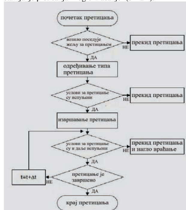
Slika 1. Algoritam toka preticanja u kompjuterskoj simulaciji
