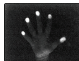
Slika 2. FTIR slika koju detektuje kamera (senzor)
