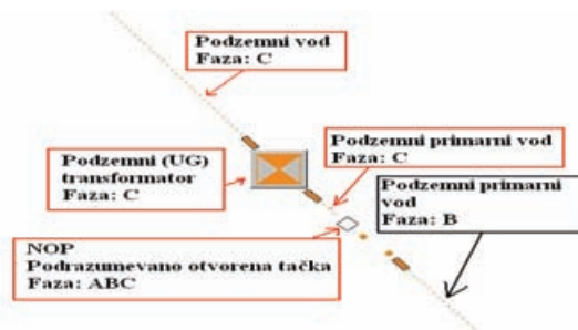
Slika 7. Transformator u DMS-u
