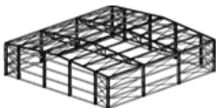
Slika 8. Izgled hale sa zategama
