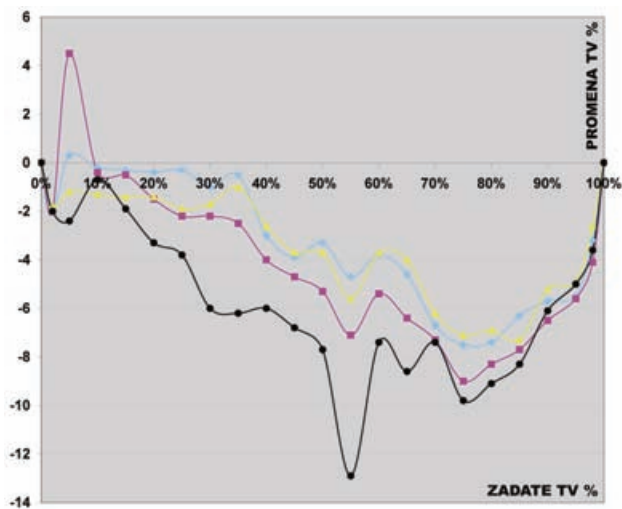
Sl. 6. Promena tonskih vrednosti – 4 procesne boje (mereno na ploči)
