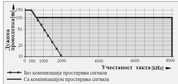
Сл. 5. Утицај дужине проводника на учестаност такта са и без компензације времена простирања сигнала
