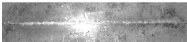
Slika 6. Izgled korena šava uzorka 1.
