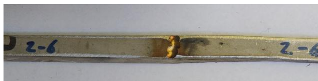
Слика 1. Узорак број 2 са највећом конкавношћу, доња позиција
