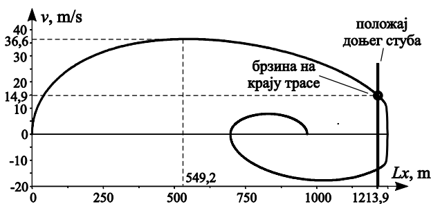
Слика 7. Дијаграм брзине у функцији хоризонталног растојања између стубова [6]
