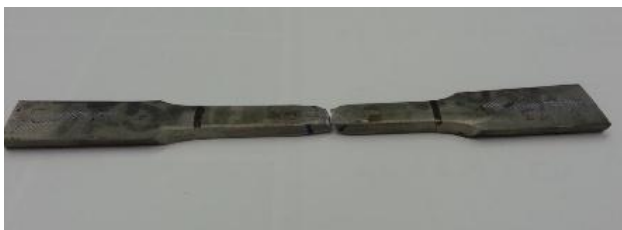
Слика 4. Изглед епрувете након испитивања затезањем за узорак број 1
