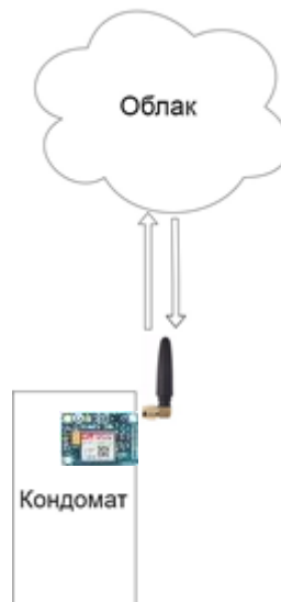
Slika 6. Ilustracija komunikacije kondomata preko GSM/GPRS modula sa oblakom
