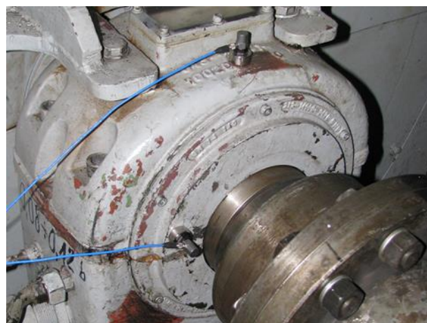
Slika 2. Način montaže senzora vibracija
