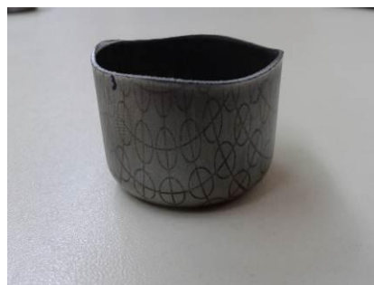
Slika 6. Obradak u procesu dubokog izvlačenja pri podmazivanju sa MoS2
