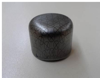
Slika 4. Obradak nakon procesu dubokog izvlačenja pri podmazivanju sa hidrauličnim uljem
