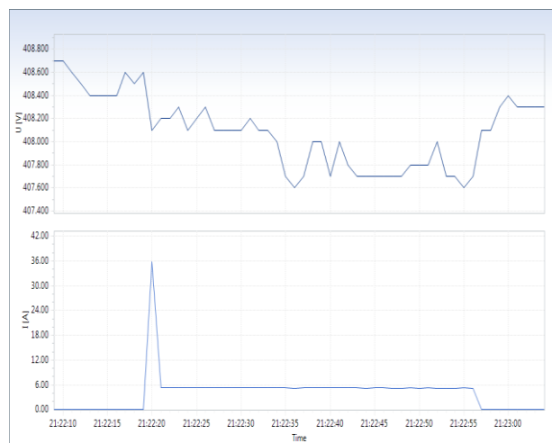
Slika 6. Napon i struja prilikom direktnog starta motora
