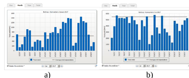
Slika 7. a) prikaz proizvodnje solarne elektrane tokom januara 2017. god., b) prikaz proizvodnje tokom jula 2017. god. [5]
