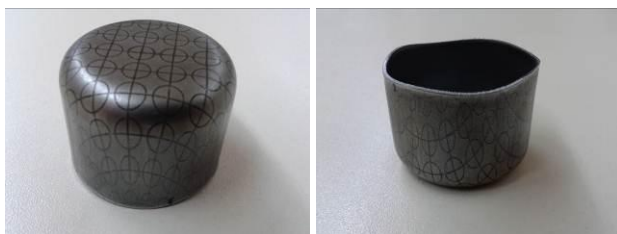
Slika 2. Obradak nakon procesa dubokog izvlačenja bez korišćenja mazivnog sredstva
