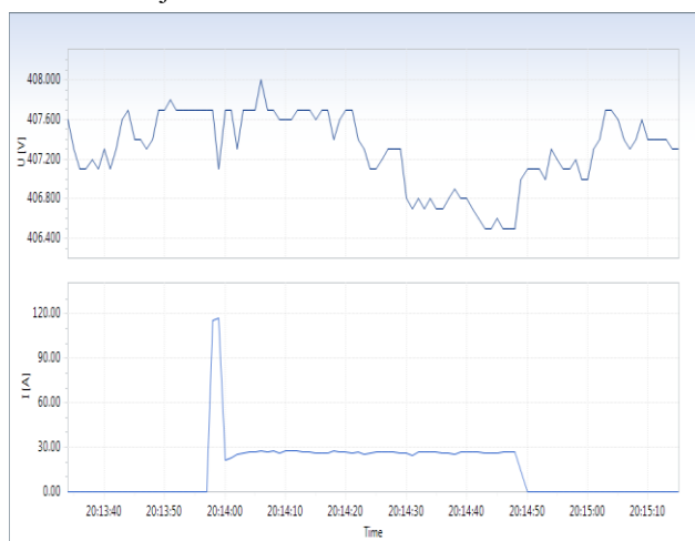
Slika 8. Napon i struja prilikom puštanja u rad pomoću soft-startera
