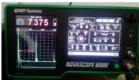
Slika 7: Prikaz dobijenih rezultata ultrazvučnim mjerenjem
