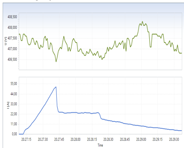
Slika 7. Napon i struja prilikom puštanja u rad pomoću frekventnog pretvarača
