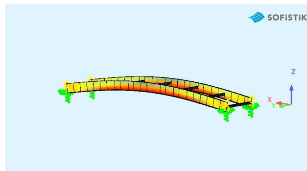
Slika 5. Faza montaže čeličnog nosača sa nadvišenjem 3d
