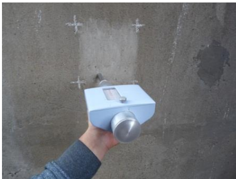
Slika 11. Ispitivanje površinske tvrdoće pomoću sklerometra
