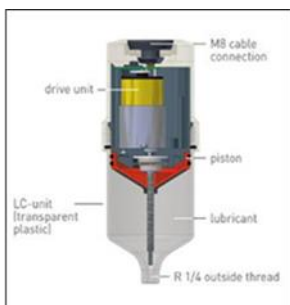
Slika 4: Presek Ketridža Star Control Impuls / Star Control Time
