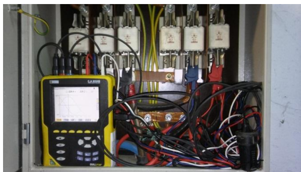
Slika 3. Postavka mernog uređaja CA 8332 u GA 110.
