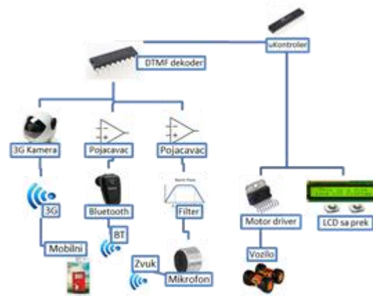
Slika 1. Blok dijagram celog sistema
