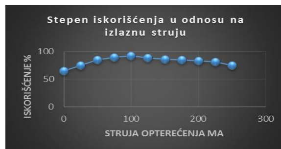
Slika 9. Zavisnost stepena iskorišćenja od struje opterećenja regulatora LMR64010 dobijena testiranjem
