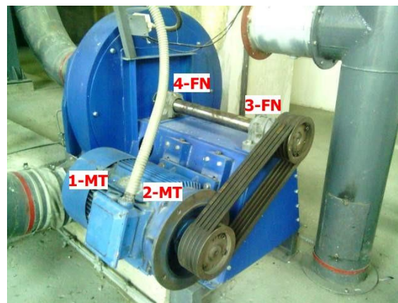
Слика 3: Вентилатор спреман за испитивање са означеним мерним местима
