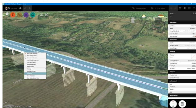
Слика 6. Мост (км 23+182,89 – км 34+657,74) дужине L=248,70\text{m}
