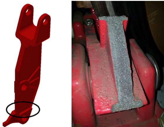
Slika 6.1 Lom velike poluge kočnice
