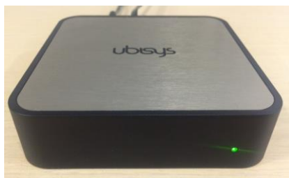
Slika 9 Gejtvej korišćen pri testiranju
