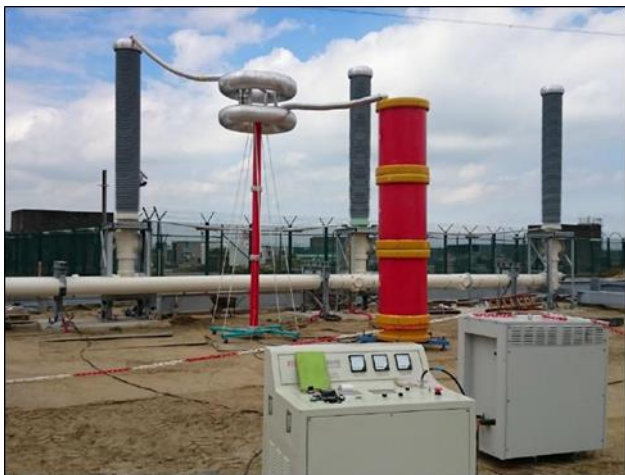
Slika 8. Način priključenja ispitne opreme
