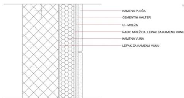
Slika 2. Varijanta 2 - kamena fasada izvedena po mokrom postupku
