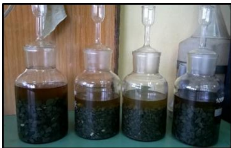
Slika 11. Određivanje stvarne zapreminske mase agregata SRPS EN 1097-6
