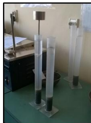
Slika 10. Određivanje ekvivalenta peska SRPS EN 933-8
