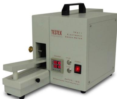
Slika 2. Uređaj za trljanje- Testex TF411 Electronic Crock Meter
