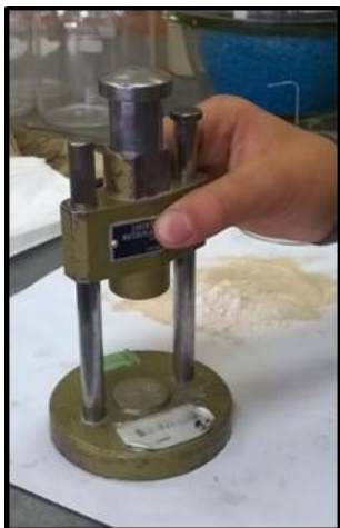
Slika 7. Određivanje šupljina u suvosabijenom kamenom brašnu EN 1097-4
