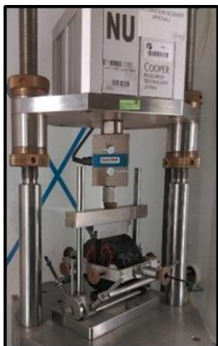
Slika 19. NAT (Nothingam asphalt tester) određivanje modula krutosti ITSM
