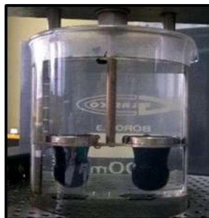
Slika 2. Ispitivanje bitumena u skladu sa SRPS EN 12594
