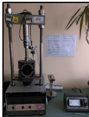
Slika 17. Određivanje stabilnosti uz pomoć Maršal prese
