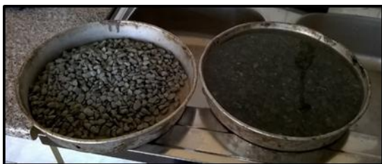
Slika 12. Određivanje upijanja vode potapanje uzorka SRPS EN 1097-6
