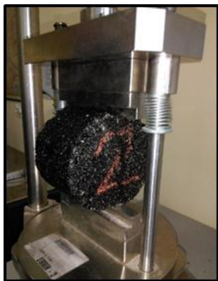
Slika 18. Određivanje indirektnu zatezne čvrstoće SRPS EN 12697-23
