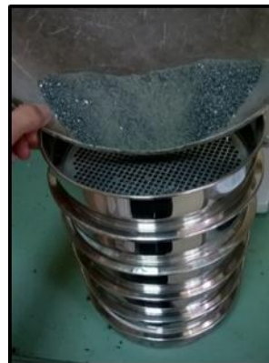
Slika 8. Priprema sita i sejanje agregata
