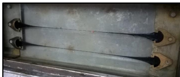
Slika 3. Opit određivanja vrednosti duktiliteta bitumena
