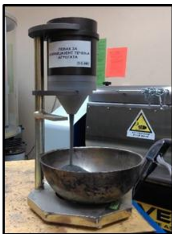
Slika 14. Levak za određivanje koef. tečenja agregata
