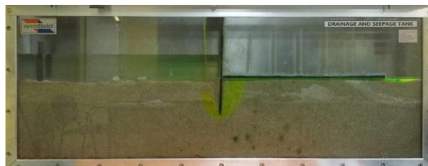
Slika 2. Vizualizacija strujnica ubrizgavanjem farbe
