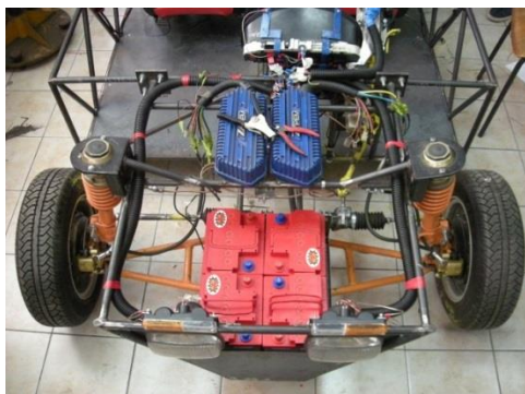
Слика 2. Предња осовина са електромоторима у точковима и батеријама на предњем препусту
