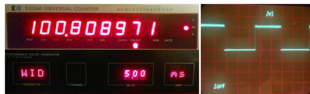
Slika 9. Dinamički režim, struja 1 A, frekvencija 1 KHz, faktor ispune 50%, 500 mA/pod
