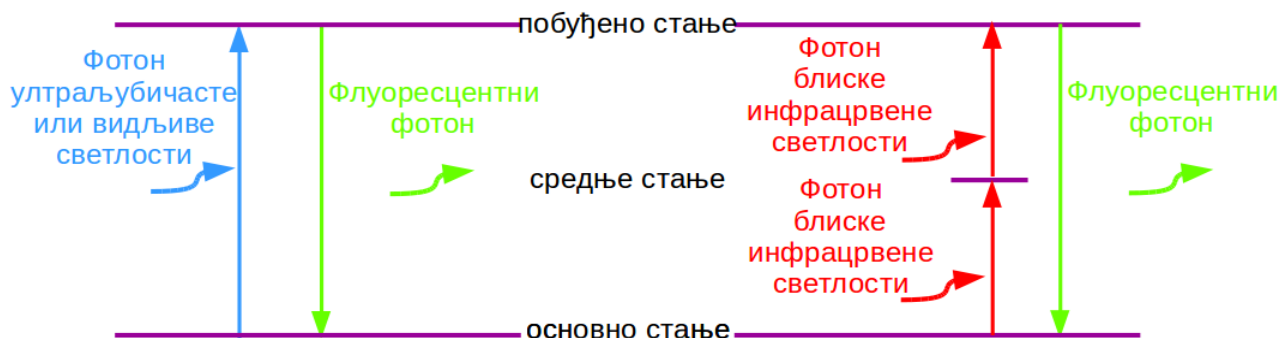
Слика 1: Упростићен приказ процеса побуђивања једним фотоном (лево) и процеса побуђивања са два фотона (десно)
