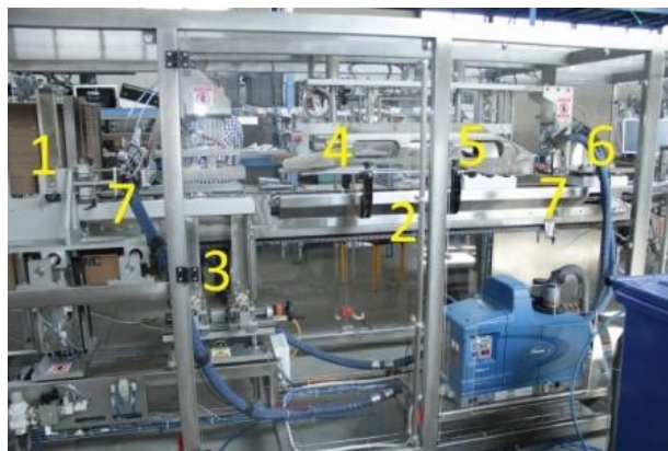
Slika 1. Mašina za formiranje kartonskih kutija
