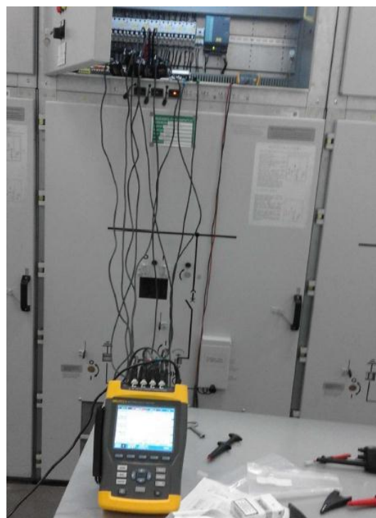
Slika 1. Način priključenja mernog uređaja.
