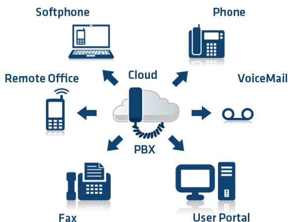
Slika 1. Prikaz cloud PBX centrale
