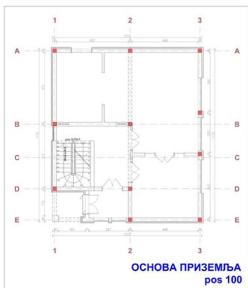
Слика 6. Места израде армирано-бетонских вертикалних серклажа
