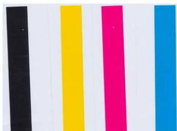
Slika 6. Uzorci skenirani poslije 7500 ciklusa na 170 g/m 2 mat premaznom papiru
