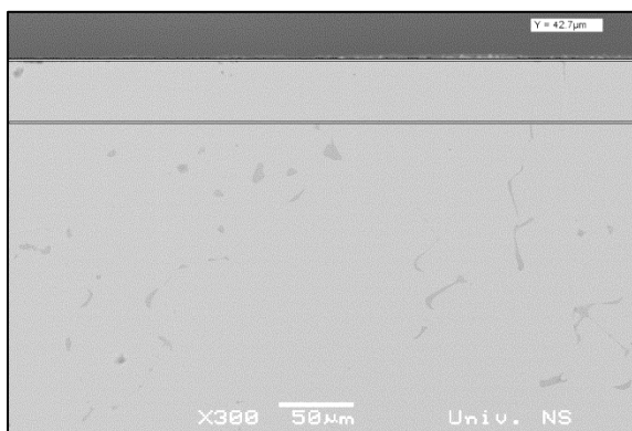
Slika 9. Zona bez karbida (SEM - poliran uzorak)
