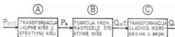
Slika 11. Šematski prikaz konstrukcije merodavnog računskog hidrograma. Model padavine-oticaaj
