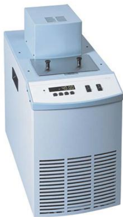
Слика 3.1. Уљано купатило, модел: CTR-80
