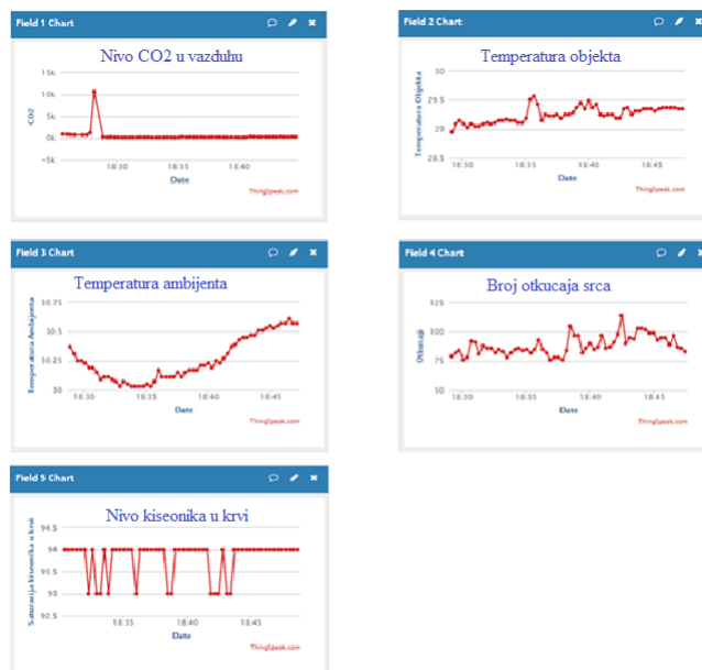
Slika 6. Očitavanje rezultata na ThingSpeak aplikaciji
