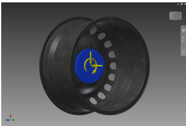
Slika 3. Čelični naplatak sa opterećenjima koja djeluju na njega u varijanti 1
