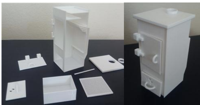
Slika 10. Delovi peći i sklop dobijeni FDM postupkom
