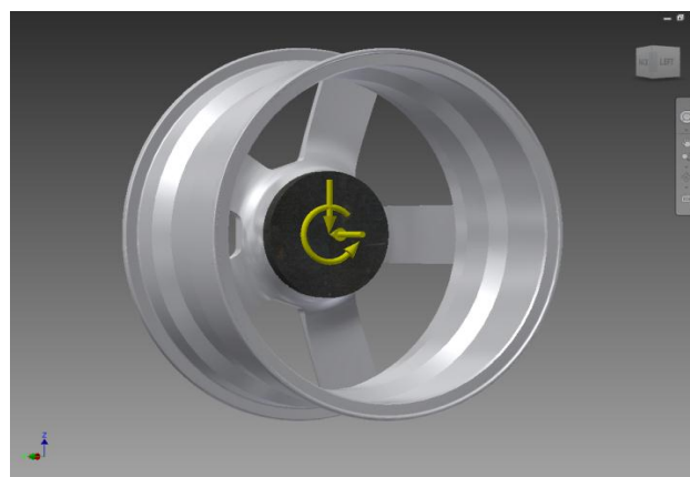
Slika 6. Aluminijumski naplatak sa opterećenjima koja djeluju na njega u varijanti 2
