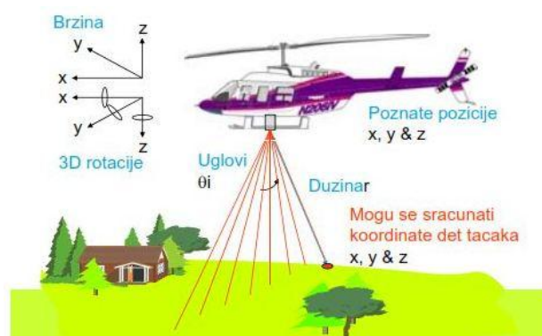
Slika 1. Princip snimanja LiDAR tehnologijom
