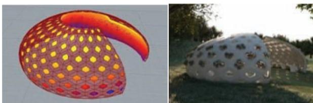
Slika 2. i Slika 3. Analiza osunčanosti uz pomoć Ecotecta na primjeru Eko paviljona i 3D prikaz
