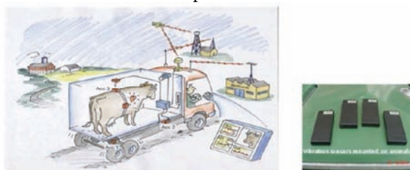
Slika 2. (a) Skica svih senzora u vozilu, video kamera i GPS-a (b) senzori vibracija koji se postavljaju na životinjama [1]
