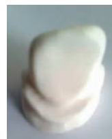
Slika 6. Zub izrađen FDM tehnologijom
