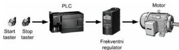
Slika 3. Šematski prikaz pogona koji radi bez HMI programa [4]
