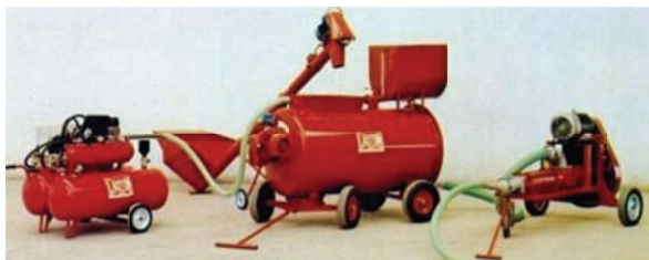
Slika br 2.-Oprema za proizvodnju peno-betona
