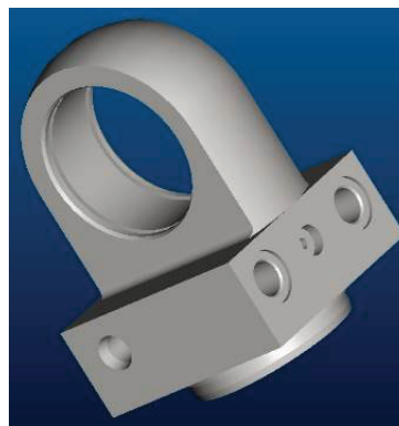
Slika 1. Model glave hidrauličnog cilindra – proizvod predstavnika
