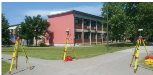
Slika 4. Merenje pomoću GPS-a u statičkom režimu rada
