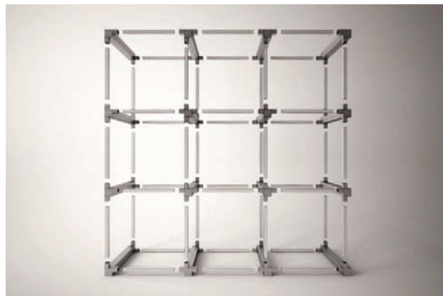
Slika 1. Perspektivni prikaz rastavljene konstrukcije
