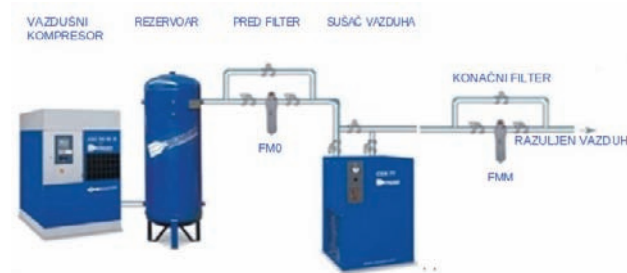
Slika 3: Način povezivanja elemenata za proizvodnju i pripremu vazduha pod pritiskom
