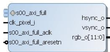
Slika 3. Blok šema zapakovanog core-a GPU_AXI_zed_board_0
