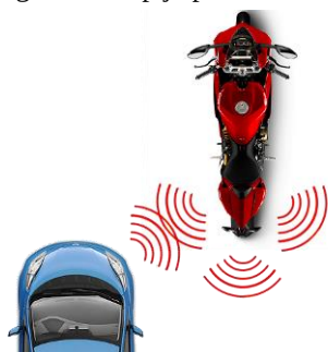
Slika 2.2. Način postavljanja ultrasoničnih senzora
