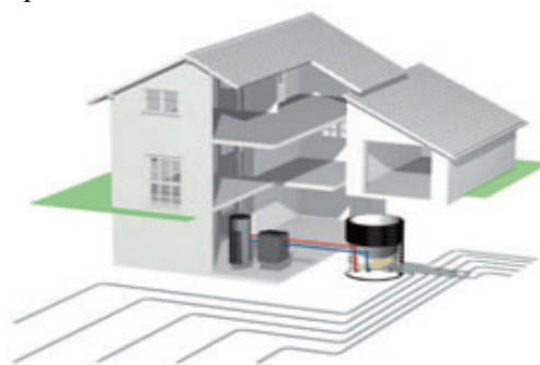
Slika 2 – prikaz horizontalnog razvoda kolektora
