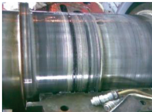
Slika . 2.: Oštećenje rukavca u zoni ležaja br.7.
