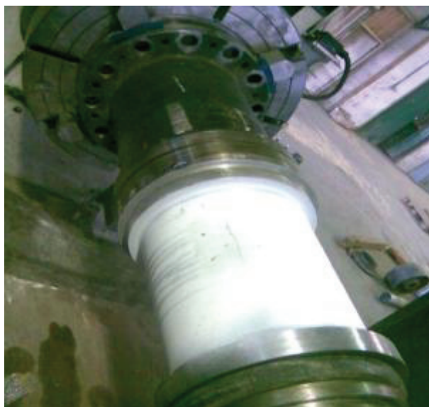
Slika 3.: Oštećenja nastavka osovine generatora
