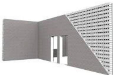
Slika 5. Unutrašnji pregradni zidovi d=22cm
