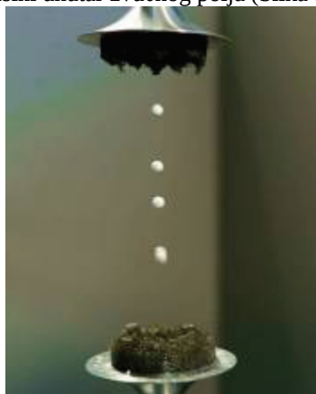
Slika 1. Akustička levitacija kuglica od stiropora.
