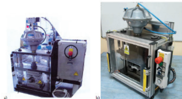
Slika 7. Mašina za zakivanje osigurača: a) Mašina sa osnovnim zaštitnim elementom; b) mašina nakon sprovođenja TPM kaizena i instalacije dodatnih zaštitnih elemenata
