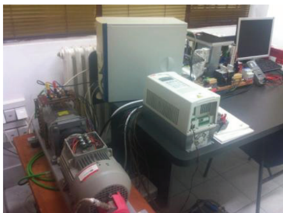
Slika 4: Pogon SMSM i energetska elektronika
