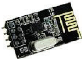
Slika 8. Bežični modul nRF24L01
