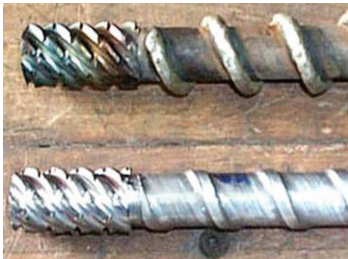
Slika 5. Izgled pohabanog puža ( donji puž ) i puža koji je i dodatno zahvaćen korozijom.
