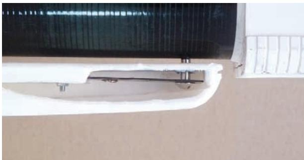
Slika 2. Detalj uređaja gde se vidi opruga sa mernim mostom
