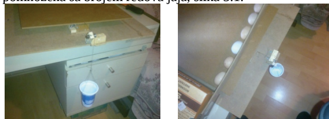
Slika 3.1 – Postavka za određivanje sile potrebne za pomicanje platforme
