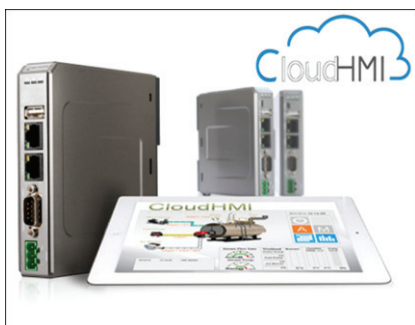
Slika 6 – HMI Cloud server i tablet za vizuelizaciju stanja i upravljanje [4]
