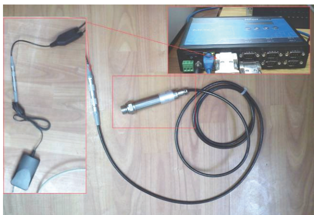
Slika 5. Povezivanje meteorološkog senzora
