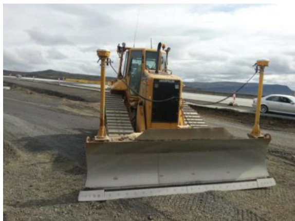
Слика 2. Булдожер са machine control технологијом
