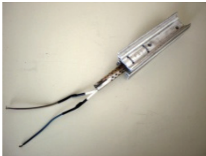
Slika 3.6 – Grejač 40W sa dodatim aluminijumskim elementom
