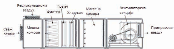
Slika 1. Šematski prikaz klima komore
