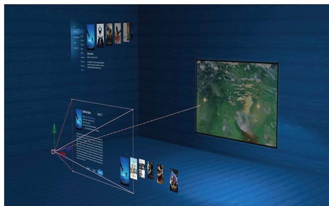
Sl. 2. Raspored video sloja i grafičkih elemenata u 3D prostoru.
