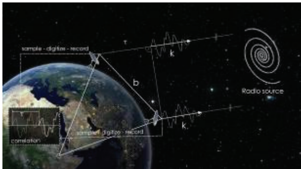
Slika 2. Princip rada VLBI
