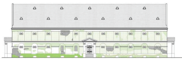
Slika 2. Prikaz degradacije ulične fasade
