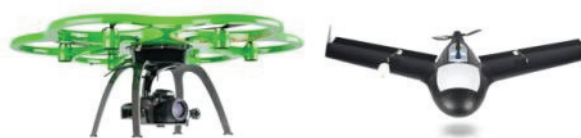
Slika 1. Bespilotne letelice: Multirotor (levo) i Fixed Wing (desno)
