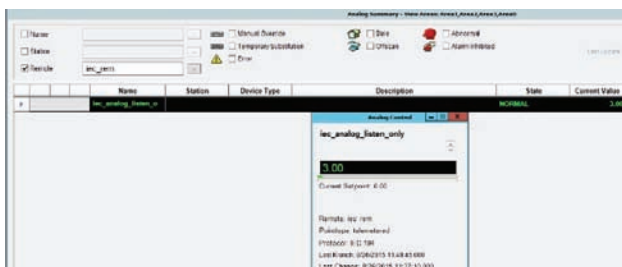
Slika 7.3: Prikaz analogne vrednosti na SCADA listen only serveru
