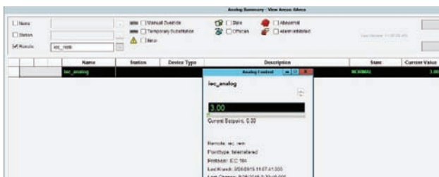
Slika 7.1: Vrednost analogne tačke na SCADA remote poll serveru
